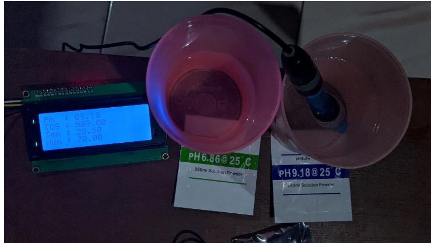
Gambar 7. Hasil pengujian sensor pH
