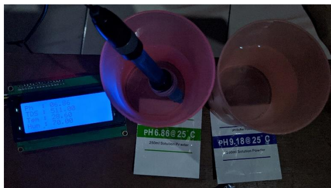
Gambar 6. Hasil pengujian sensor pH
